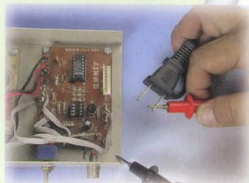
Figura 2.30. Midiendo contacto a tierra
